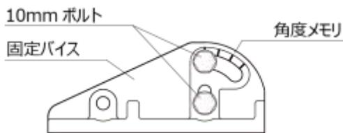
固定バイスの2本のボルトをT型レンチで緩め、バイスの角度メモリをベースの角度のいずれかに合わせます。合わせたら2本のボルトをT型レンチで強く締めてください。
